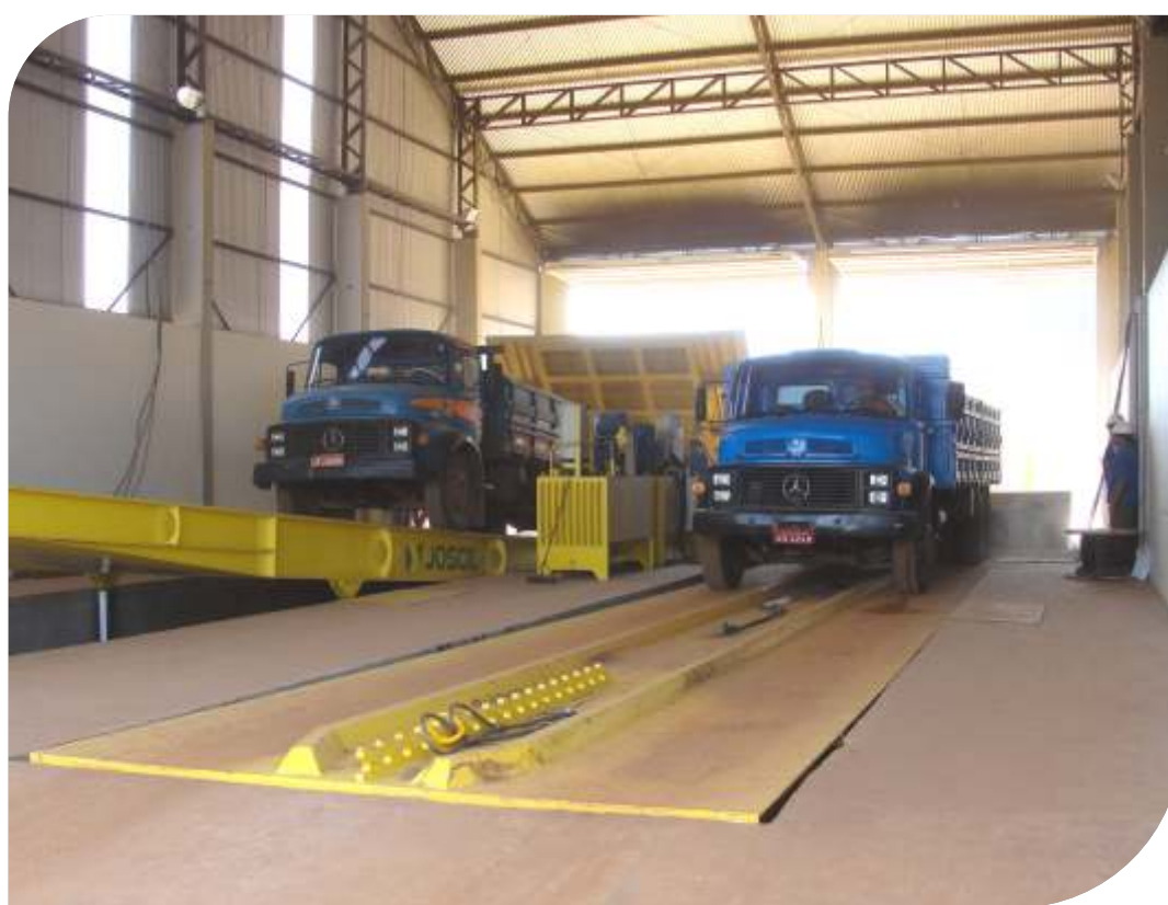
Tombadores garantem dinamismo, agilidade e segurança na descarga de grãos.
